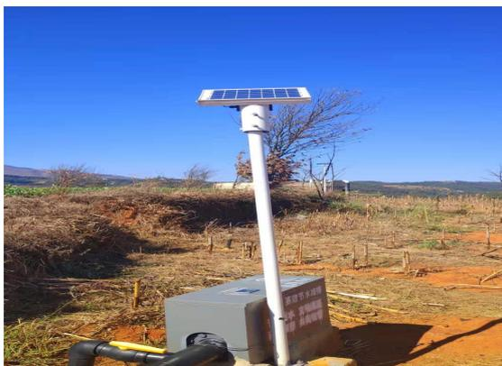
智能 IC 卡取水计量系统装置
